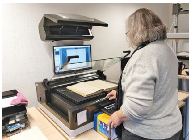
Abb. 1: Die Scanarbeitsplätze im Stadtarchiv – links der Buchscanner / Aufsichtsscanner mit Buchwippe; rechts der Großformatscanner
