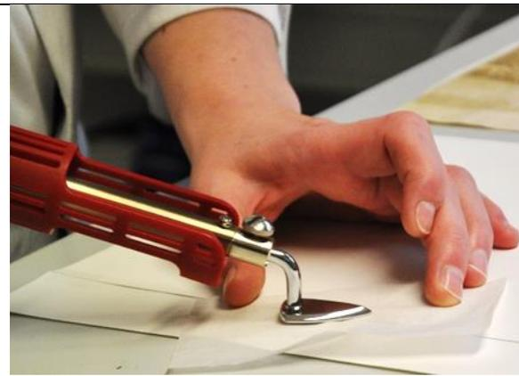
3. Es wird ein Seidenpapier darübergelegt und das Archibond® wird mit dem Bügeleisen aufgebügelt, bis es durchsichtig wird.
