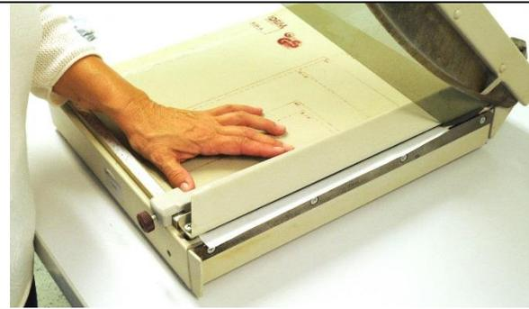
1. Es wird ein passender Archibond® - Streifen mit dem Hebelschneider zugeschnitten.
